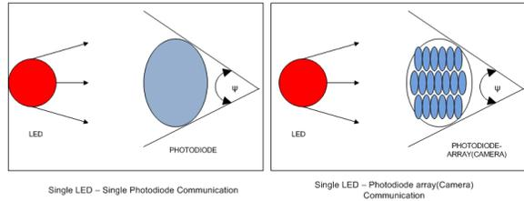
**Figure 1: LED-Photodiode/Camera Communication Illustration**
